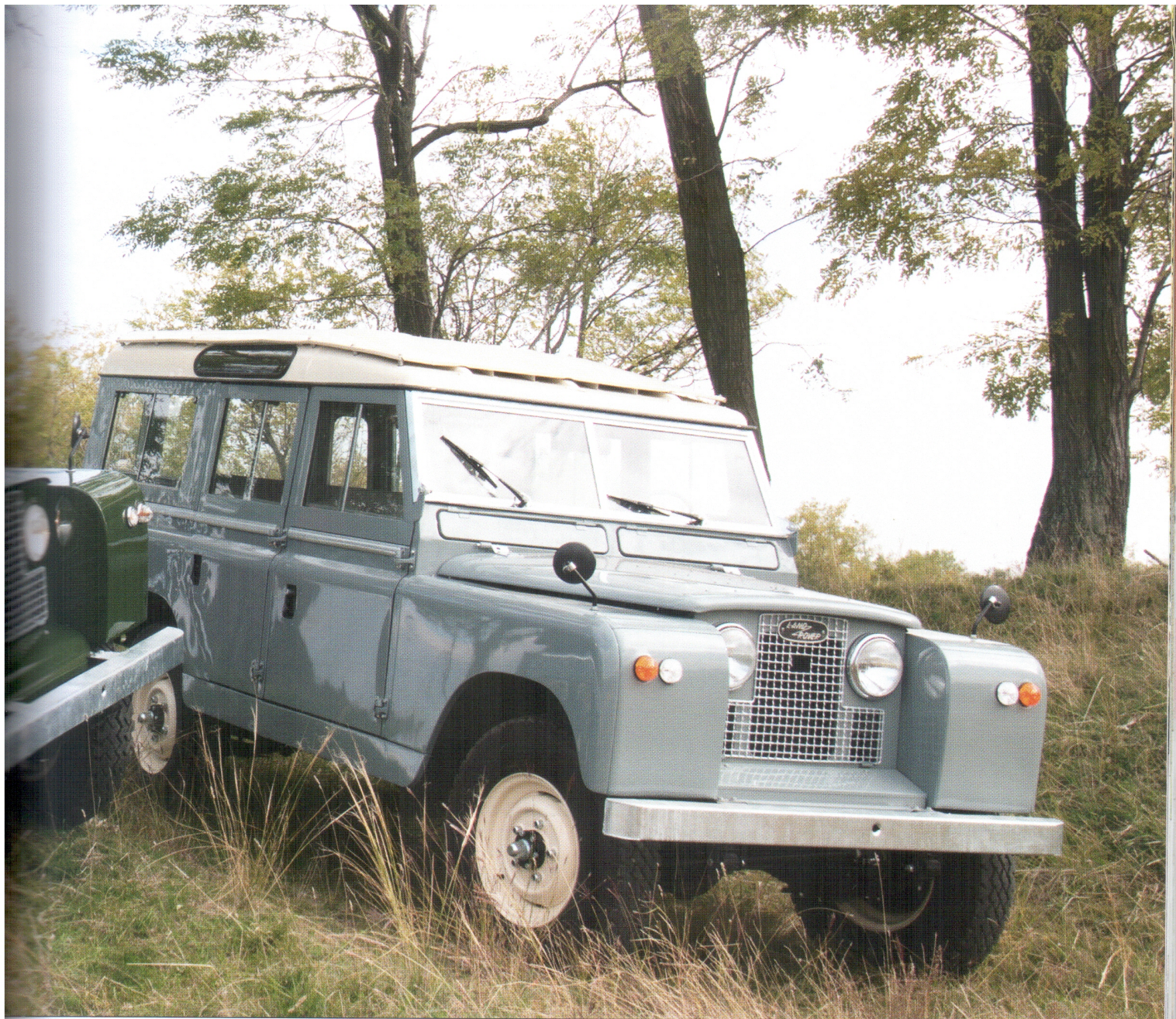
Jól látszódnak a tetők felső lemezei alatt a Safari tető szellőzőnyílásai
